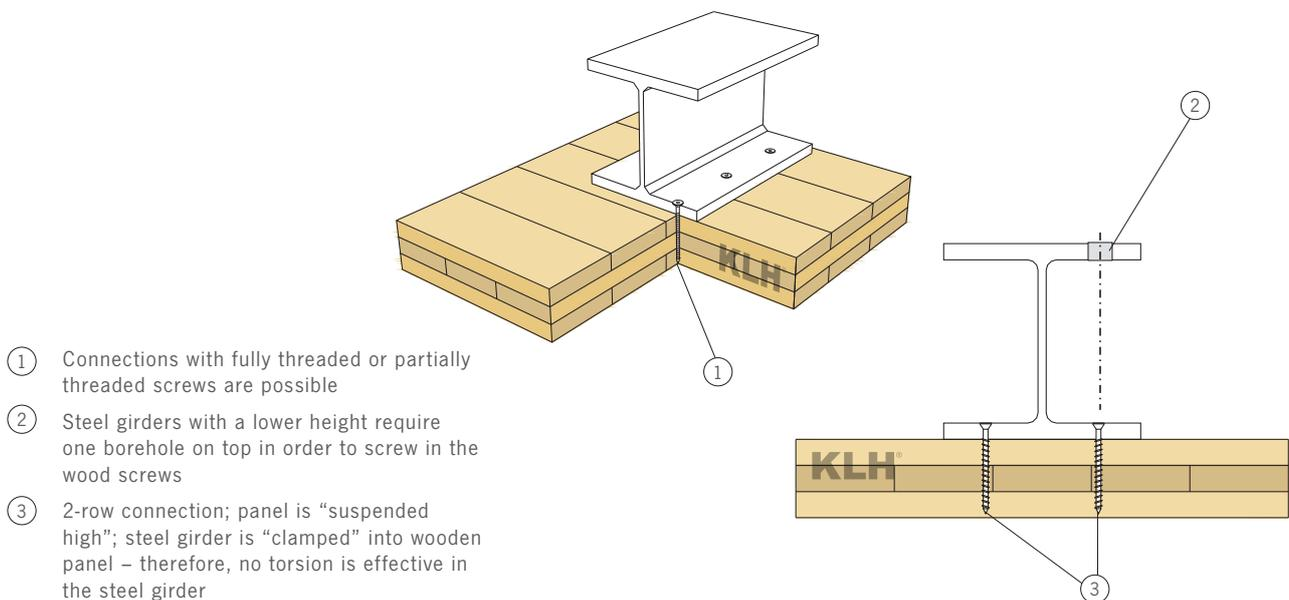
CEILING/ROOF CONNECTION TO STEEL GIRDER
